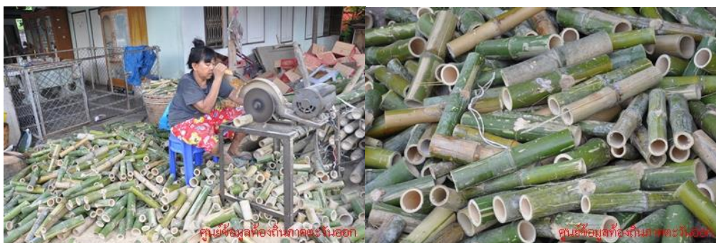
การตัดกระบอกไม้ไผ่
